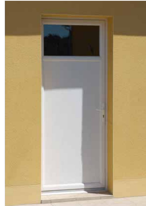
Porte de service vitrée Isolation thermique : Ud = 1.4W / [m2°C] Panneau : 2 faces PVC + mousse (option) Vitrage : 44.2 (classe 2) Serrure : 5 points avec poignée contreplaqué
